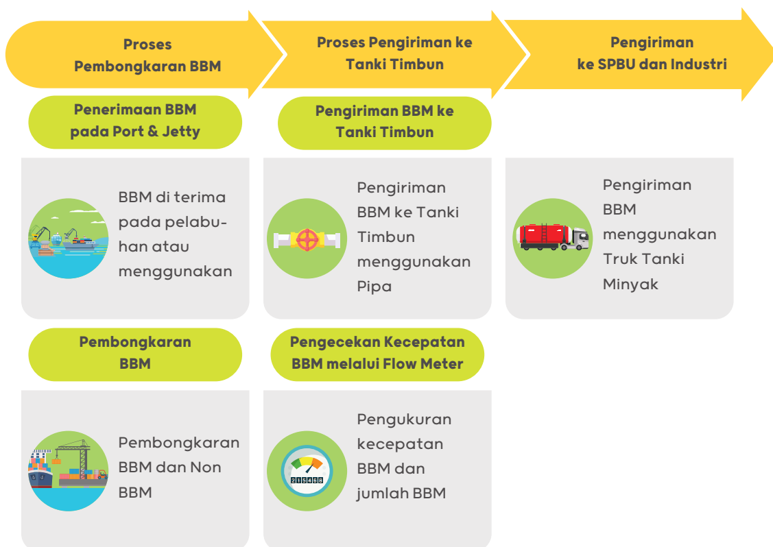
Gambar 3.5 Proses Pembongkaran dan Pengiriman Biosolar
